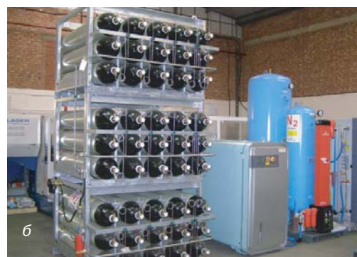
Рис. 2. Азотные компрессоры Sauer (35 МПа) в системе лазерной резки металлов: а – WP4331; б – TORNADO WP3215
